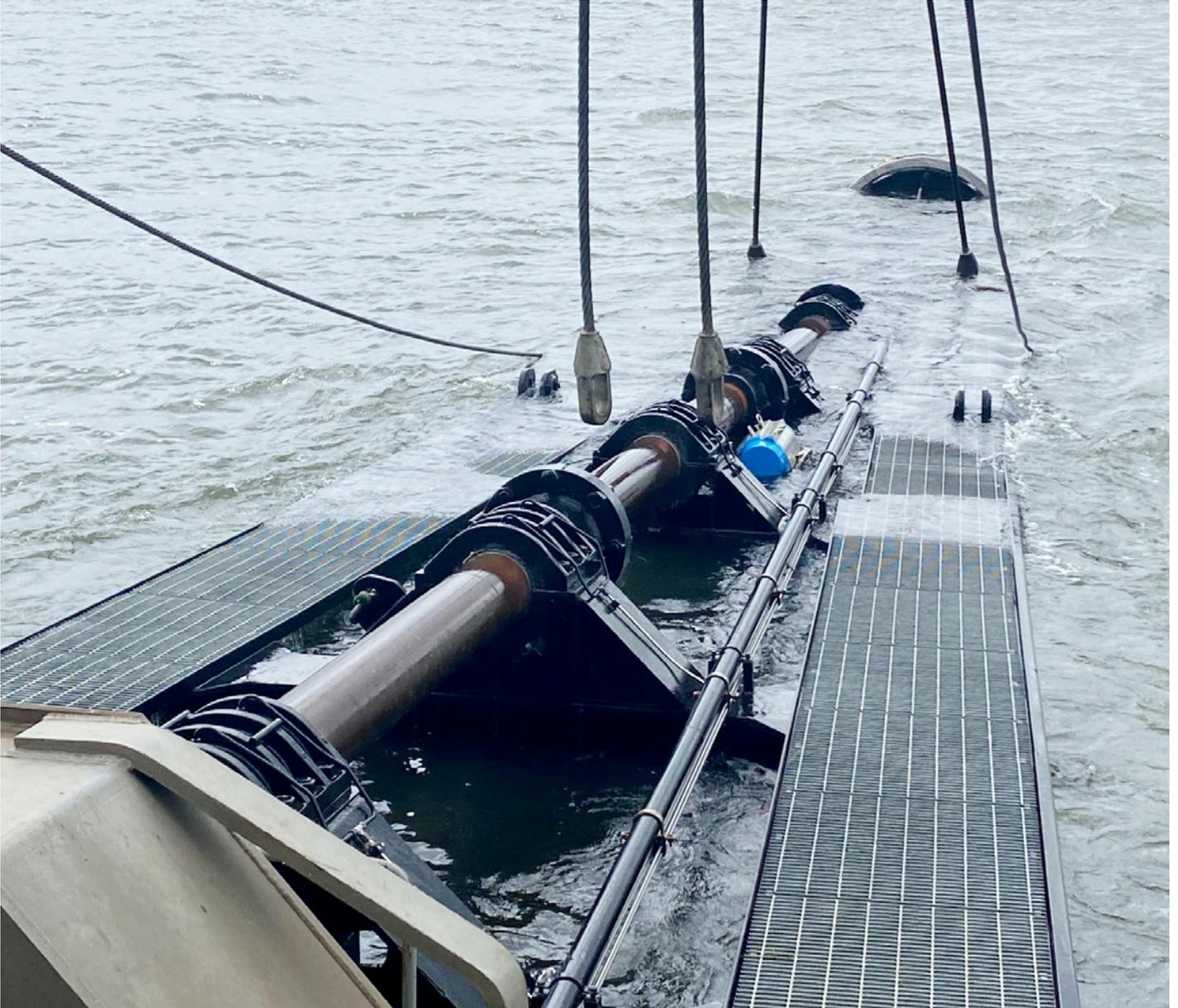
Die zuverlässig funktionierenden pneumatischen Antriebe beherrschen die Armaturensteuerung in jeder Einbaulage und unabhängig davon, ob der Bohrarm über oder unter Wasser arbeitet.
